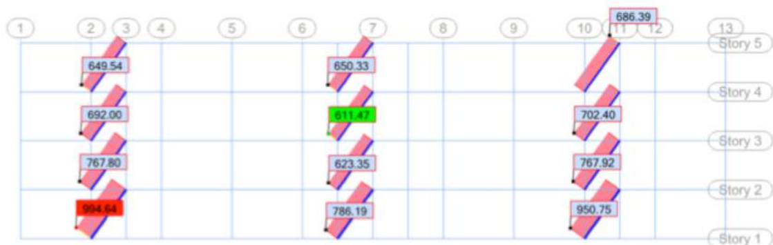
1.21 Optredende spanningen in de stabiliteitsverbanden ( q = 1 ).
