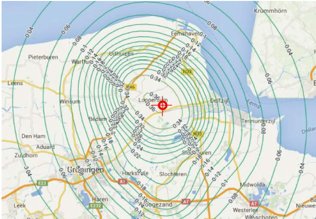
4.8 Figuur 3.1 uit NPR 9998 met de gebouwlocatie.
